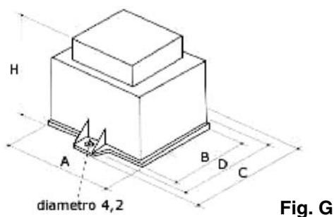
**Modello in resina autoestinguente (dimensioni in mm.)**
